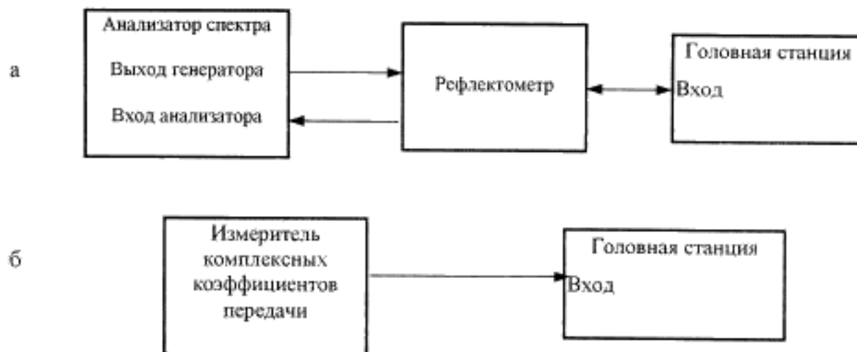
Рисунок 7.15 — Структурная схема для измерения затухания несогласованности
