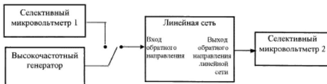
Рисунок 7.9 — Структурная схема для определения уровня радиосигнала на входе обратного направления, наклона АЧХ в полосе частот обратного направления и отношения радиосигнала с цифровой модуляцией к одночастотной помехе в канале обратного направления
