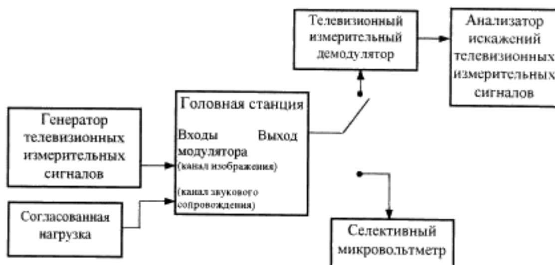
Рисунок 7.21 — Структурная схема для определения отношения радиосигнала изображения к внеполосной помехе и измерения параметров канала изображения
