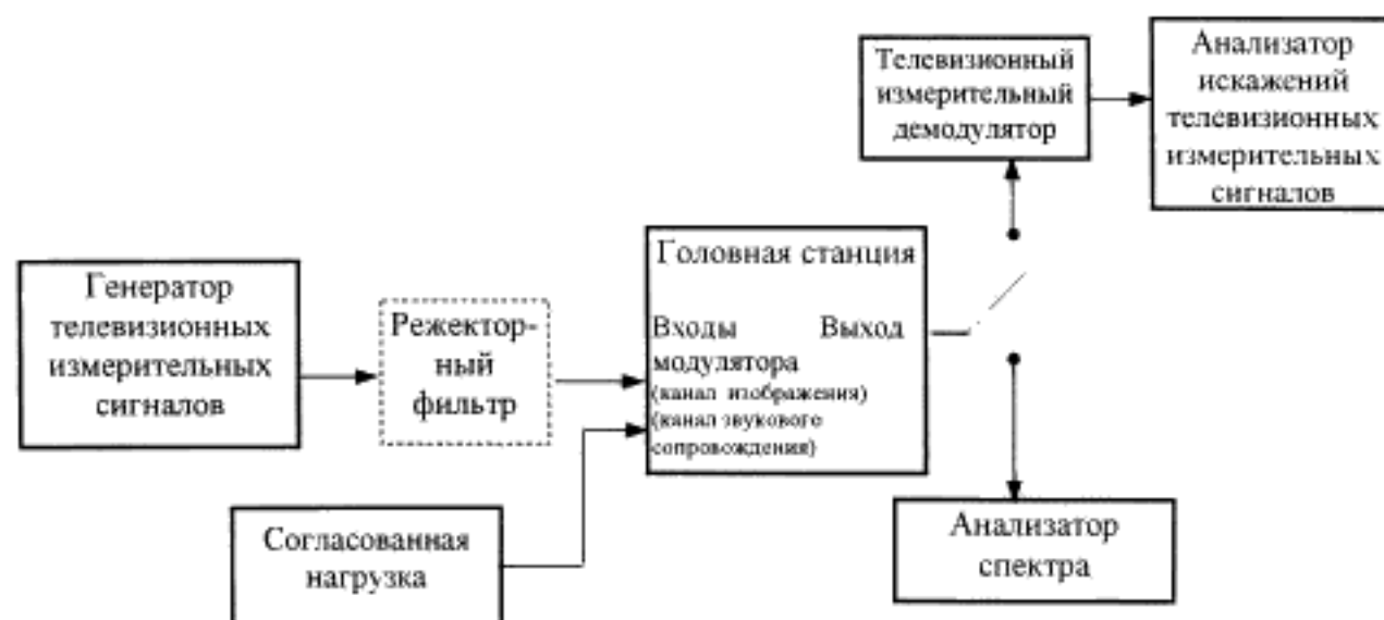
Рисунок 7.18 — Структурная схема для определения отношения радиосигнала к одночастотной помехе комбинационных частот третьего порядка IMA_{III(K)}
