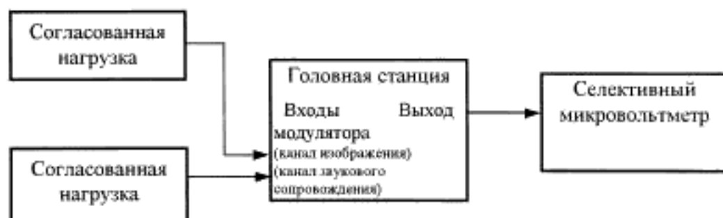
Рисунок 7.19 — Структурная схема для определения отношения радиосигнала изображения к побочным помехам, разности уровней напряжения радиосигналов изображения и звукового сопровождения, отношения радиосигнала изображения к шуму в полосе частот канала изображения
