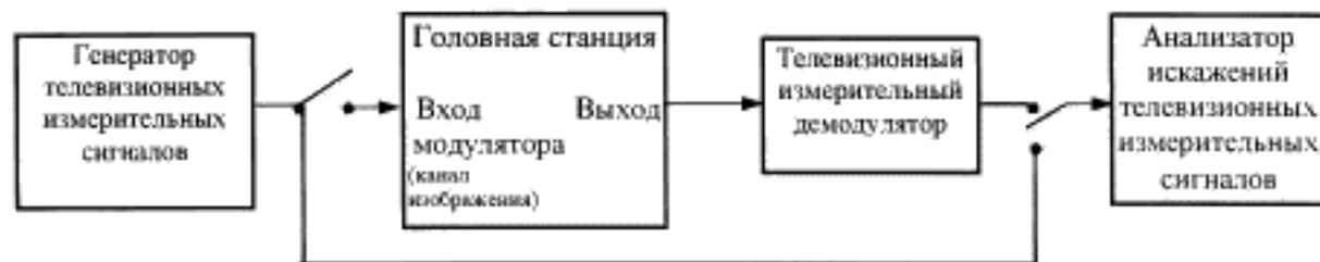
Рисунок 7.17 — Структурная схема для измерения размаха полного цветного видеосигнала на входе телевизионного модулятора
