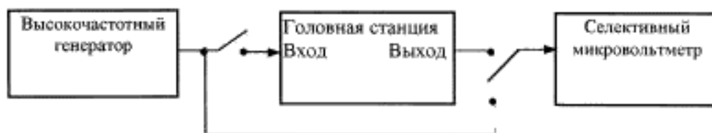
Рисунок 7.11 — Структурная схема для определения диапазона входных уровней напряжения радиосигнала изображения, эффективности автоматической регулировки усиления, диапазона регулировки выходного уровня напряжения
